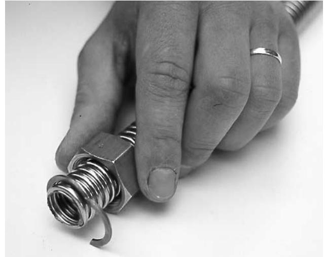
Bild 5 Überwurfmutter auf Schlauch schieben. Dann Klemmring in das erste Wellental einlegen und zusammendrücken. Wenn Sie eine Rohrzanze verwenden, Schlauch bitte nicht beschädigen.
