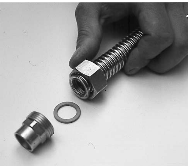
Bild 8 Wenn Sie die Verbindung endgültig zusammenschrauben, bitte Dichtung einlegen!
