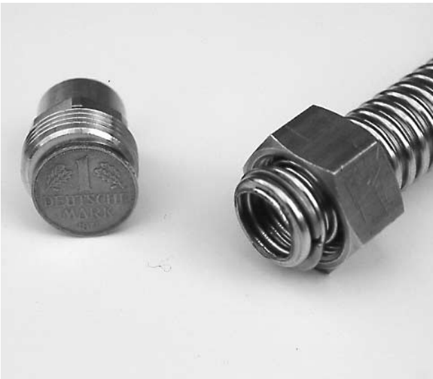
Bild 6 Jetzt wird die Welle am Rohrende zu einer Dichtfläche zusammengestaucht. Hierzu dient die Unterlegscheibe b.z.w. ein IDM-Stück, die in die Überwurfmutter eingelegt wird.
