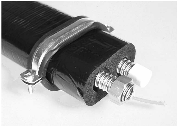
Bild 1 Hochflexibles, gedämmtes Doppel-Rohr, 2 x DN16 Wellschlauch aus Edelstahl mit 14 mm HT Twinflex-Isolierschlauch \lambda = 0,040 W/mK, kurzzeitig temperaturbeständig bis 190°C, robuste und UV beständige Außenhaut, integriertes Fühlerkabel, 4 Anschlussverschraubungen für 18mm Cu-Rohr, 8 Ovalschellen mit Stockschrauben und Dübel, zusätzliches Isolierstück u. Klebeband, Länge 15m (Artikel-Nr. 150 300 19).
