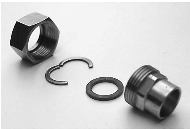
Bild 2 Die schnelle und zuverlässige Twinflex-Verbindung besteht aus: Überwurfmutter, Klemmring, Dichtungen 3/4" und Nippel 3/4"-18 mm.
