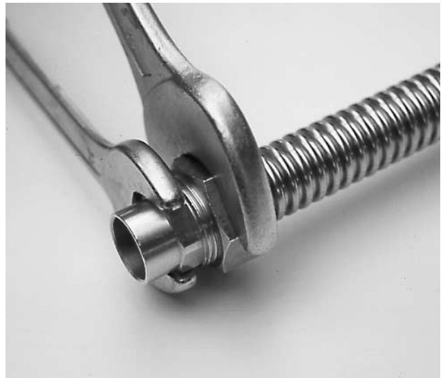
Bild 7 Überwurfmutter mit einem Schraubenschlüssel halten und Übergangsnippel fest einschrauben. Anschließend Übergangsnippel und Unterlegscheibe bzw. IDM-Stück wieder herausnehmen.
